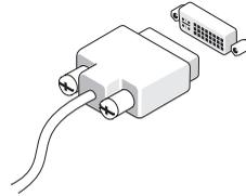
c VGA-Kabel mit DVI-Adapter
